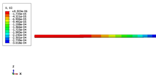
Figura 7.11 - Diagrama de desplazamientos ABAQUS Aluminio.
