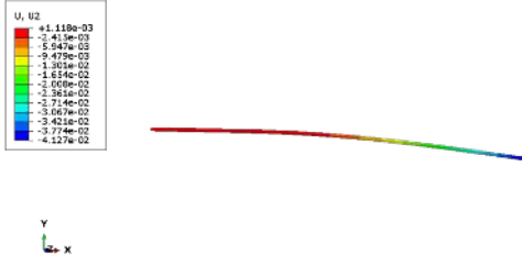
Figura 7.13 - Diagrama de desplazamientos ABAQUS Fibra de Carbono.
