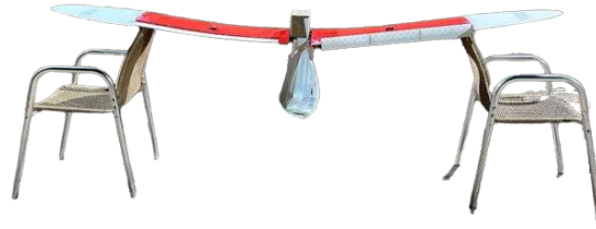
Figura 7.9 - Prueba de flexión estática del ala.
