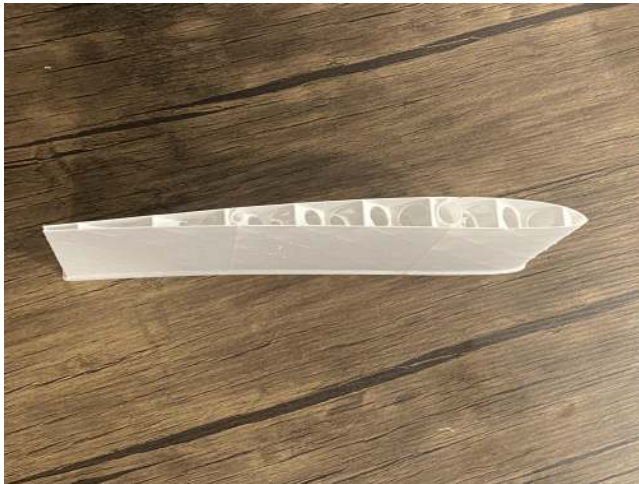
(a) Sección de estabilizador fabricado con LW PLA mediante impresión 3D.
