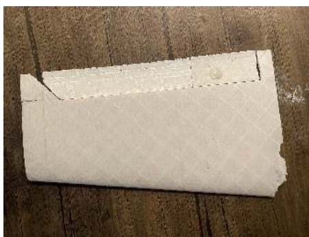
Figura 26: Prototipo de prueba del estabilizador de la cola en V del dron.
