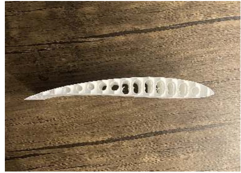
(b) Sección del ala fabricada con LW PLA mediante impresión 3D.
