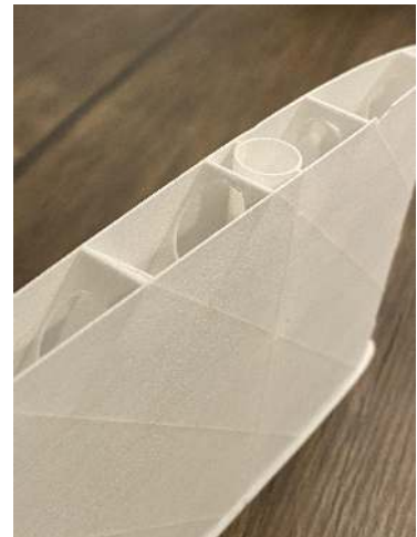
(b) Detalle de la estructura del estabilizador.
