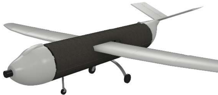
Figura 36: Renderizado del dron con la carga visible a lo largo de todo el fuselaje.
